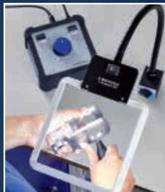
Entgratsystem MTQ mit beleuchteter Schutzscheibe
